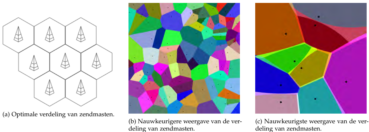
Figuur 1.2: Schematische weergaven van enkele verdelingen van zendmasten.
